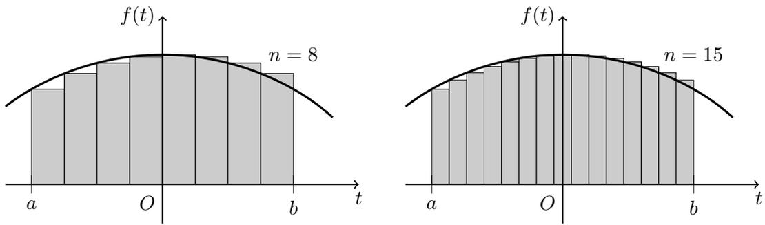
On découpe l'intervalle  $[a, b]$  en  $n$  morceaux ( $n \in \mathbb{N}^*$ ), le coin en haut à gauche de chaque rectangle est en  $y_i = f(x_i)$ . On approche l'aire sous la courbe par la somme des aires des rectangles : la fonction retourne la somme de l'aire des  $n$  rectangles.
