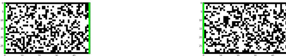
Les deux dessins ci-dessus ont tous les deux été fait avec chaque fois une probabilité de 60% qu'un carré donné soit conducteur. Le système de droite est globalement isolant, alors que celui de gauche est globalement conducteur (on suppose que le courant ne peut pas passer entre deux carrés conducteurs qui ne se touchent que par un coin ; il faut une arête en commun pour que le courant passe). Ci dessous un chemin reliant les deux électrodes pour le système de gauche :
