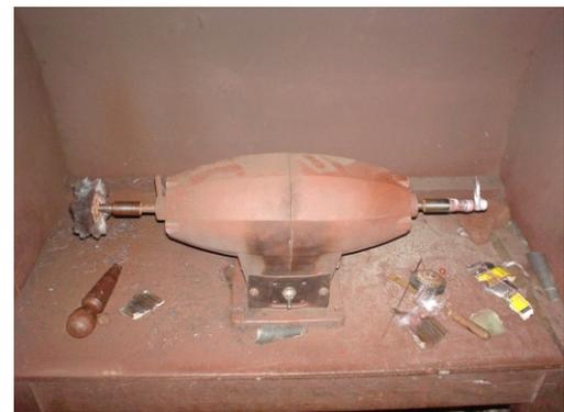
polit l'intérieur de la bague sur du papier de **Figure 18 Machine à polir** même moteur électrique.
