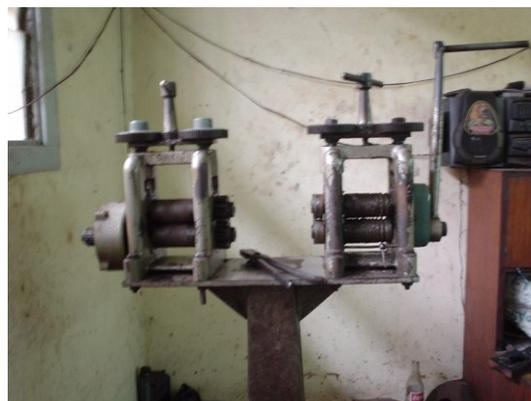
Figure 6 la machine à tréfiler et à laminier
