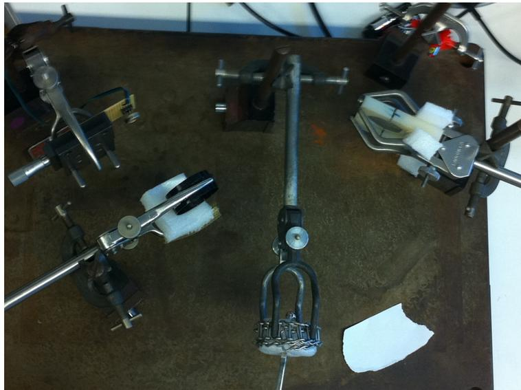
FIGURE 26 – Montage 4 : scann du pied du diapason
