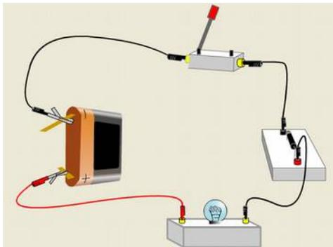
Dipôles : pile, interrupteur, diode et ampoule.
