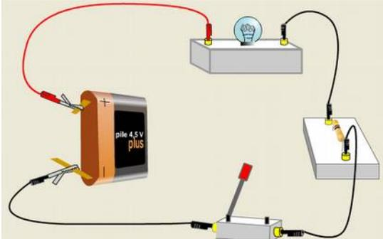
Dipôles : pile, ampoule, résistance et interrupteur.
