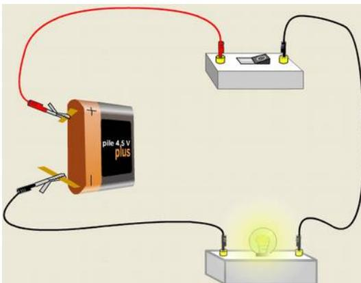
Dipôles : pile, interrupteur et lampe.
