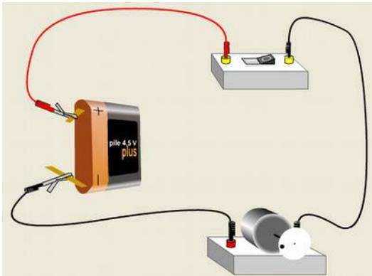
Dipôles : pile, interrupteur et moteur.
