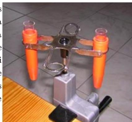
Figure 2 : photo de centrifugeuse.
