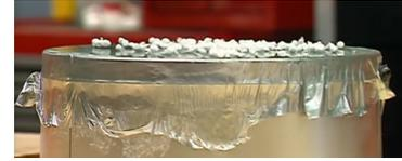
Figure 3: L'onde sonore provoquée en tapant sur la poubelle se propage jusqu'à la feuille d'aluminium. Celle-ci vibre à cause du son et fait sauter les boules de polystyrène. Tiré de [1].
