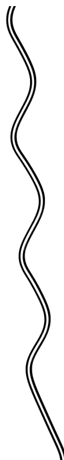
Instabilité de méandrage spontané (chapitre 5). Au-dessus d'un débit critique, le rivelet exhibe des oscillations sinueuses désordonnées, tout en gardant une épaisseur constante.
