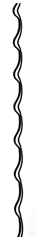
Instabilité en collier de perles (chapitre 4). En déplaçant le rivelet transversalement à haute fréquence, une instabilité se déclenche, qui couple entre elles des déformations transverses et longitudinales, toutes les deux périodiques en espace.
