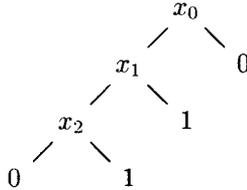
qui peut également s'écrire «  $\text{test}_{x_0}(\text{test}_{x_1}(\text{test}_{x_2}(0, 1), 1), 0)$  ». On remarquera que dans un nœud  $\text{test}_{x_i}(v, f)$ , le fil positif  $v$  est systématiquement le fil gauche, et le fil négatif  $f$  le fil droit.
