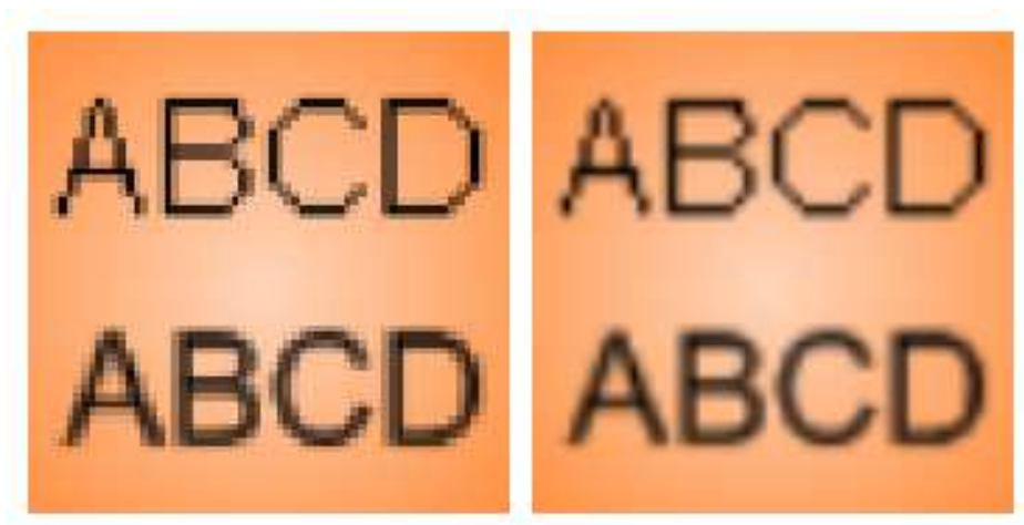
Sous-échantillonnage d'une texture, à gauche approximation par plus proche texel (pas de filtrage), à droite moyenne pondérée des 4 texels les plus proches
