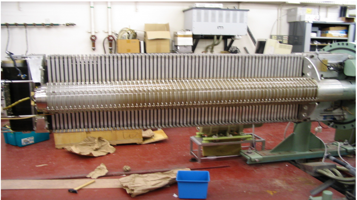
Fig. 3: Vue sur le tube d'accélération
