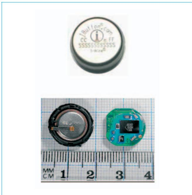
Figure 12 – Thermomètre iButton (thermo-bouton)
