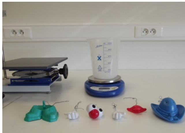
FIGURE 3 – Image du montage de mesure de la masse volumique du Mr Patate.
