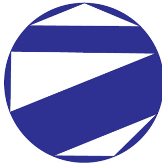
FIG. 6 – Triangulation associée à la fonction de contour de l'arbre de la figure 4 via la méthode des minimas locaux.
