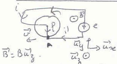
une roue (disque) de rayon  $a$ , résistance électrique  $R$  majeure  $I_0$  est placée dans un champ  $\vec{B}$  uniforme et constant, et ferme un circuit alimenté par la fem  $e$ .
