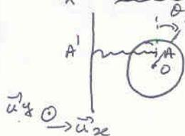
Une roue peut tourner autour d'un axe passant par son centre  $O$ . Un ressort fixé en  $A'$  est aussi fixé en  $A$  sur un rayon de la roue.
