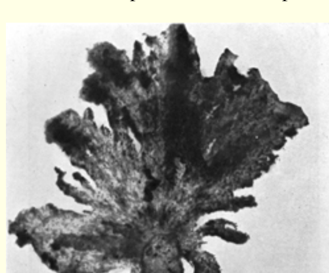
Fig 27. - Forme d'algue donnée par une graine de sels solubles de calcium et de manganèse, dans une solution de carbonates alcalins dilués.
