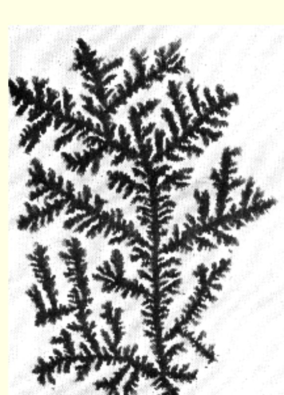
Fig. 52 - Cristallisation de chlorure d'ammonium dans la gélatine.
